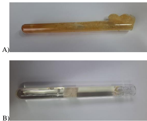
Rys. 2. Preformy z PMMA domieszkowane kropkami kwantowymi CdSe w heksanie a) preforma z dodanymi QD po procesie prepolimeryzacji, b) preforma z QD dodanymi do mieszaniny polimeryzacyjnej.
