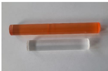
Rys.1. Preformy z PMMA oraz z PMMA domieszkowanym kropkami kwantowymi CdSe w oktadekanie (pomarańczowa preforma).
