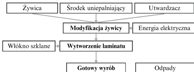
Rys. 1. Diagram przepływu dla technologii wytwarzania laminatu modyfikowanego środkiem uniepalniającym.
